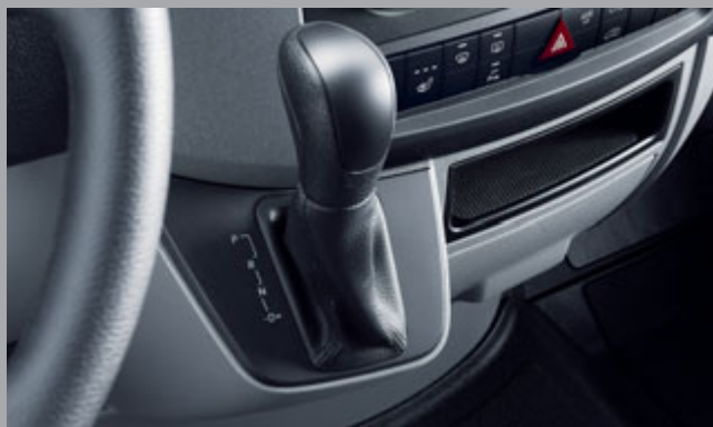
Die handliche, in das Cockpit integrierte Schaltung erleichtert den Durchstieg.
