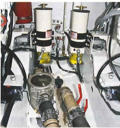
◀ Standardinstallation: Ein Filter mit Wasserabscheider pro Maschine ist die Mindestausstattung
